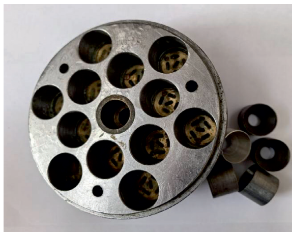
Рис. 2. Общий вид (а) и конструктивная схема (б) матрицы с конфузурно – диффузорными вставками Fig. 2. General view (a) and structural diagram (b) of the die with converging–diverging inserts
