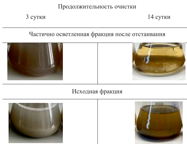
Рис. 3. Визуализация очистки картофелекрахмальной суспензии Fig. 3. Visualization of potato starch suspension purification
